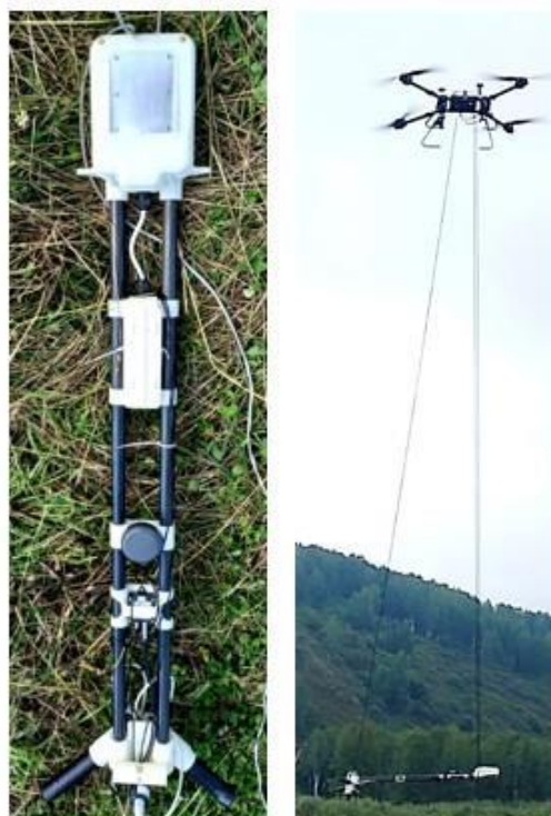
Рисунок 1. Комплекс беспилотных электромагнитных зондирований МЭМИ: буксируемый модуль (слева), размещение на носителе в ходе проведения съемки (справа).
