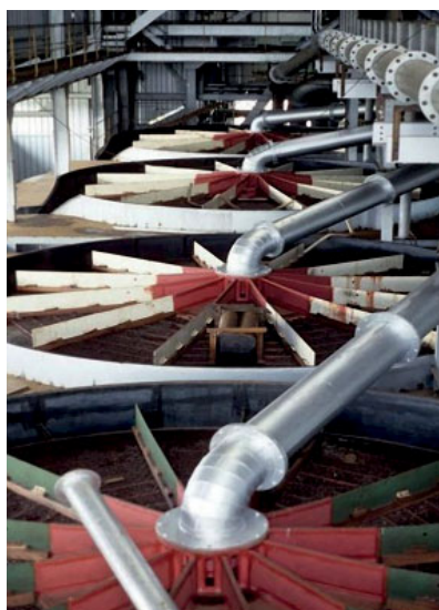
Рис. 9. Отсадочные машины ИХЦ в россыпной схеме обогащения на борту морской драги
