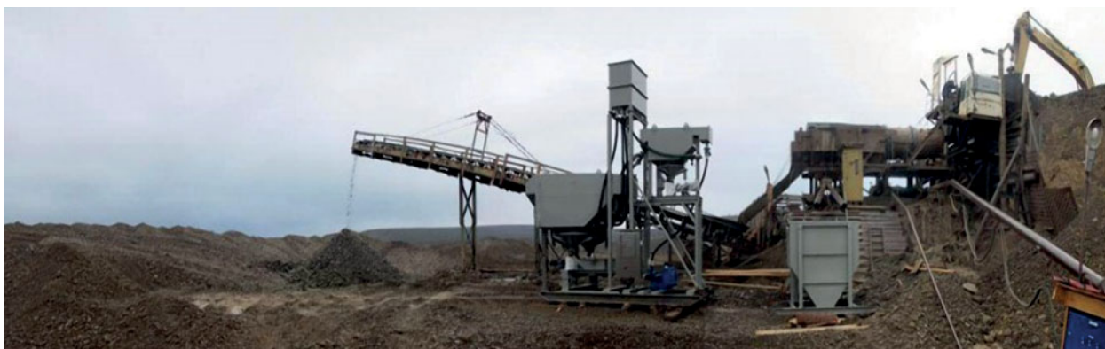
Рис. 10. Опытный отсадочный модуль ИХЦ на испытаниях на одном из россыпных производств в России
