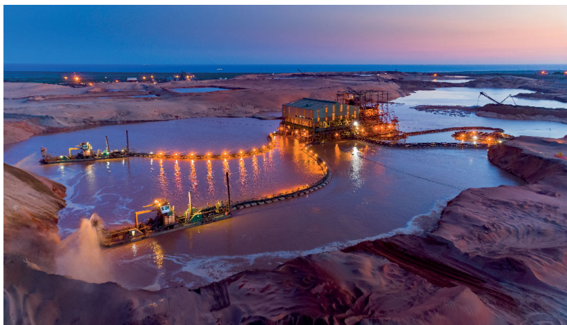
Рис. 3. Дражная добыча с применением земснарядов и плавучей фабрики
