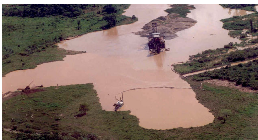
Рис. 6. Пример применения сочетания роторного земснаряда на вскрыше и черпаковой драги на добыче песков на одном из россыпных месторождений золота
