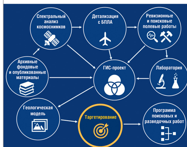
Рис. 6. Принципиальная схема геологического таргетирования, применяемая специалистами ИГТ при разработке программ поисково-разведочных работ
